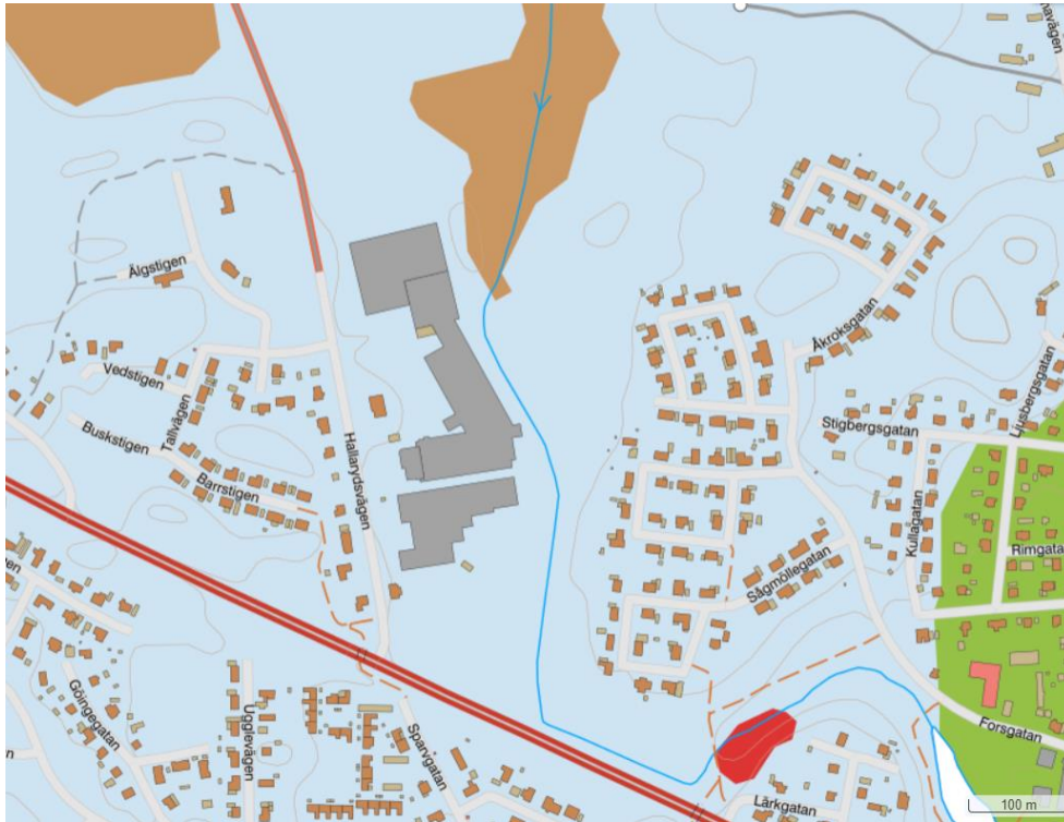
Figur 8 - Utdrag ur SGI jordartskarta. Blått representeras av morän och brunt av torv.
