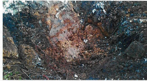
Provgrop 2 som innehöll något mer lera än första provgropen.
