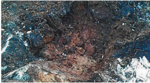
Provgrop 2 som innehöll något mer lera än första provgropen.
