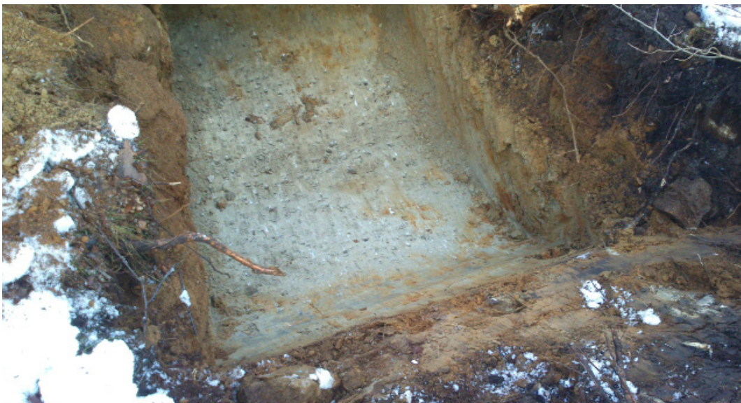
Provgrop 4. Bilden visar schaktbotten utan större stenar.
