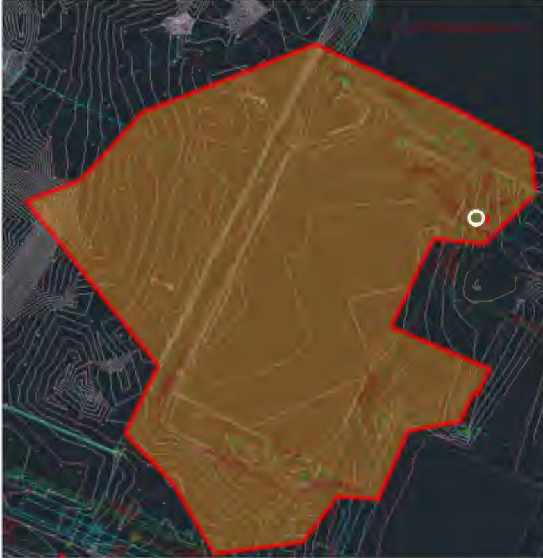
Figur 4. Avrinningsområdet ishallsytan innan ombyggnation samt befintliga ledningar.
