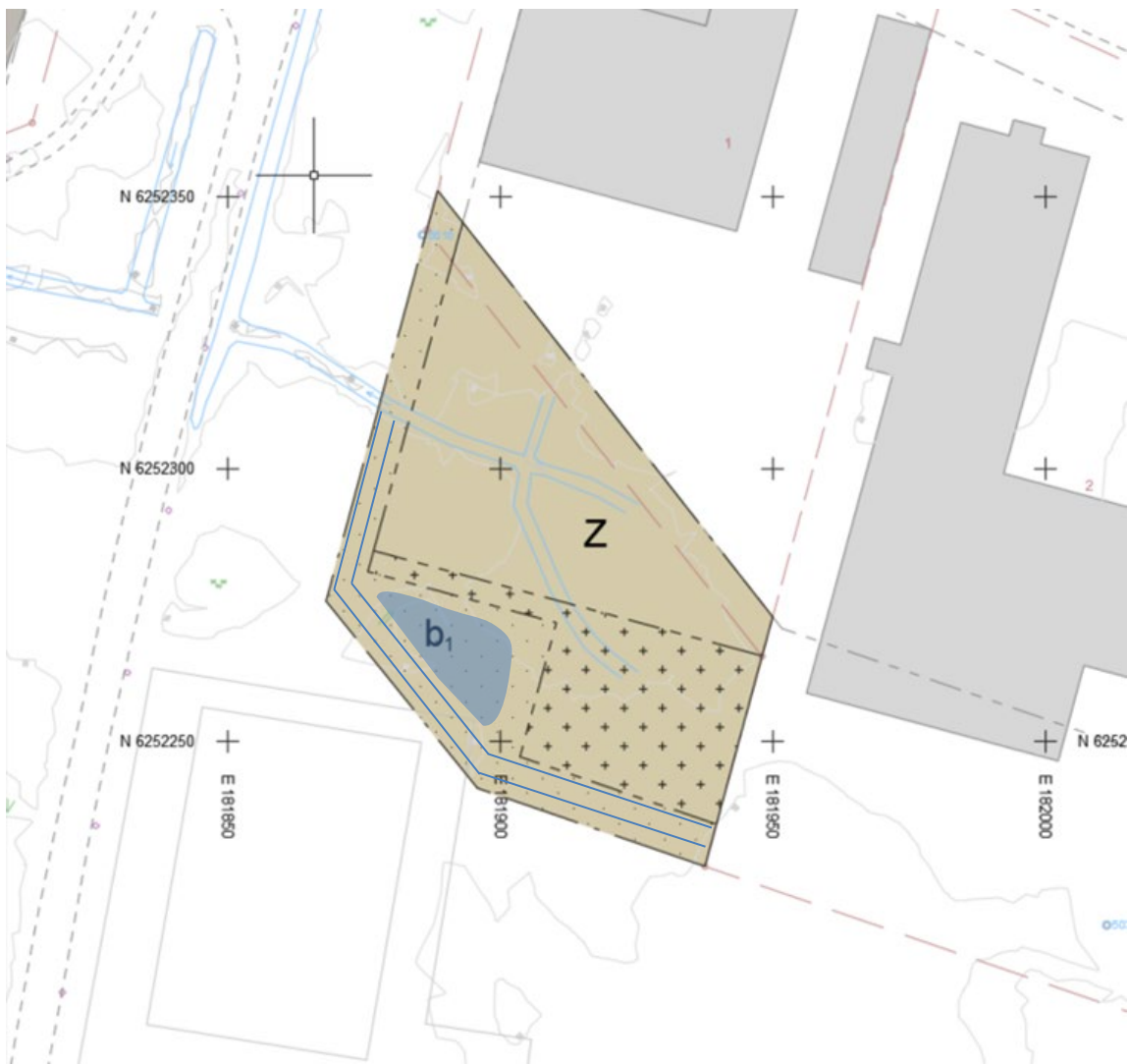
Figur 8. Illustrerad dagvattenlösning med fördröjningsdamm och ny dragning av dagvattendike.
